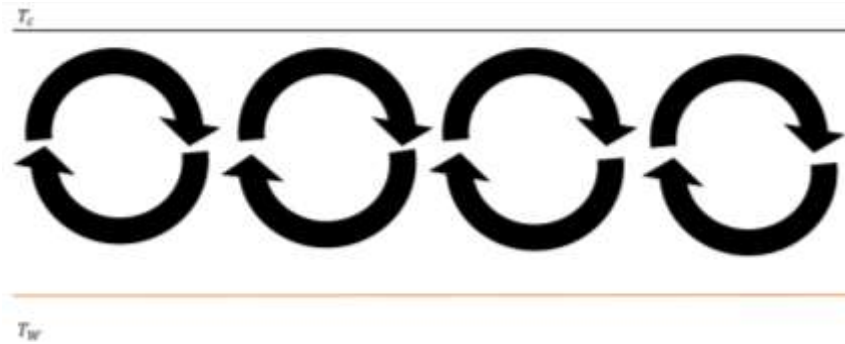
Figura 4: Modelo do rolo de Lorenz, que surge com a diferença de temperatura entre T_w e T_c com T_w > T_c .
