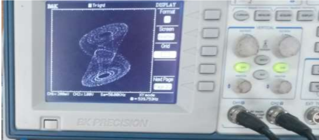
Figura 12: Circuito de chua gerando um atrator.
