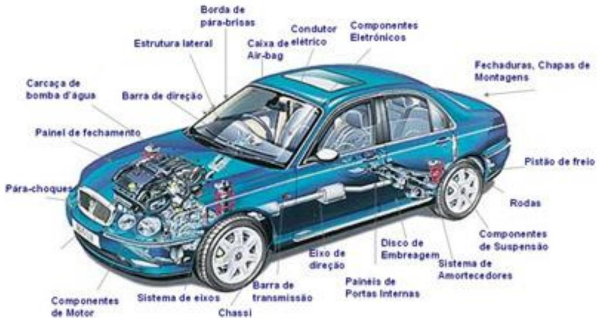
Figura 2.7 – Componentes do carro produzidos em ligas de alumínio (ALCOA, 2010)
