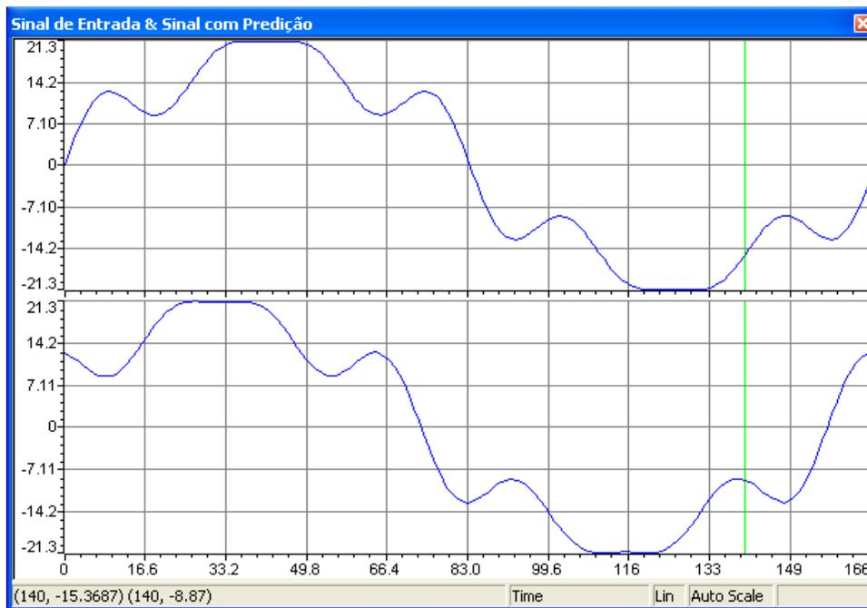
Figura 4.7: Gráfico superior: sinal com a fundamental, 5<sup>o</sup> e 7<sup>o</sup> harmônicos sem atraso. Gráfico inferior: resposta do filtro ao sinal de entrada.
