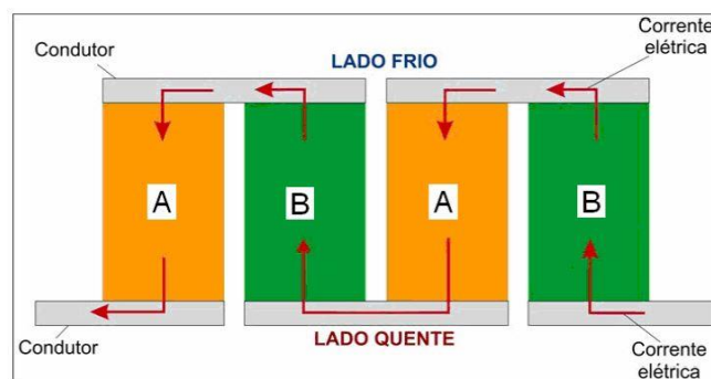
Figura 1 - Módulo termoelétrico, onde os materiais A e B se combinam para conversão de energia térmica em energia elétrica.
