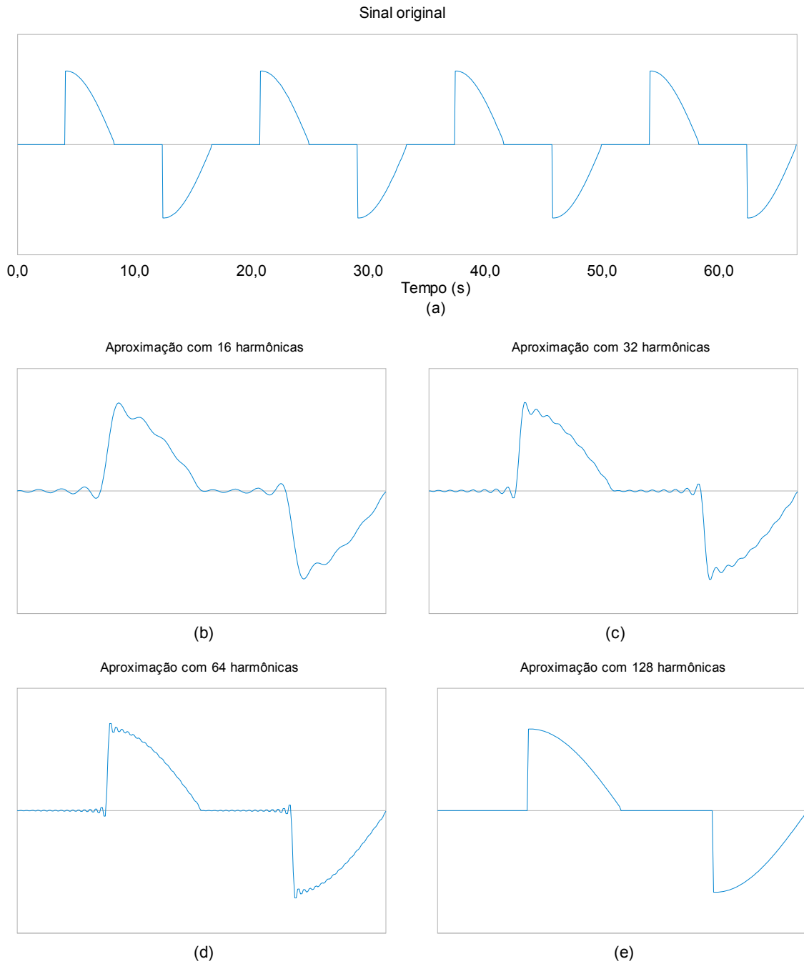
Figura 37 - Sinal (a) e suas aproximações (b)-(e) obtidas através da série de Fourier de tempo discreto.
