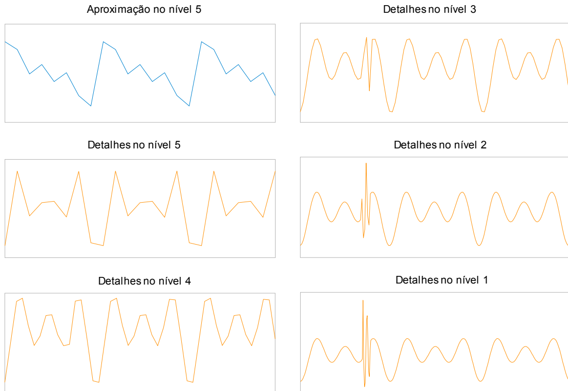
Figura 59 - Aproximação em 5 níveis da forma de onda presente na Figura 58 e obtida através da transformada discreta wavelet implementada
