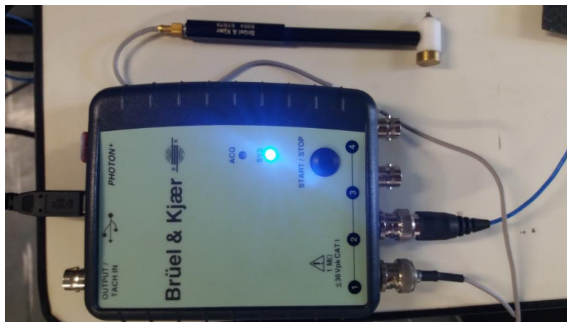
Figura 24 – Martelo utilizado para excitar dinamicamente a viga e a placa de aquisição de sinais.
