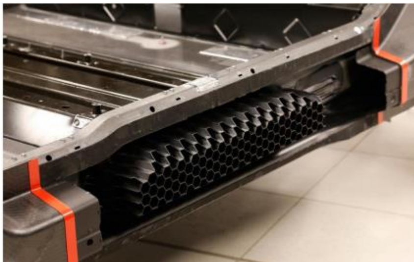
Figura 7 - Longarina do BMW i3 com honeycomb Fonte: Markus (2013).
