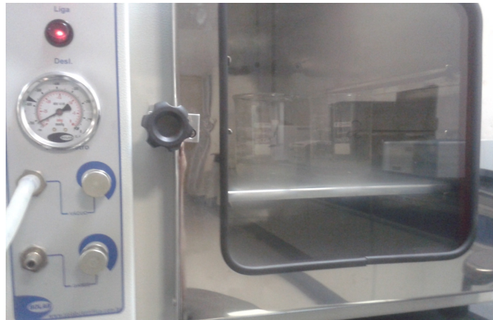
Figura 9. Processo de secagem das amostras de polioli em estufa a vácuo
