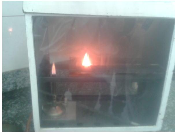
Figura 30. Corpo de prova de espuma de poliuretano durante ensaio de propagação de chama em câmara de inflamabilidade
