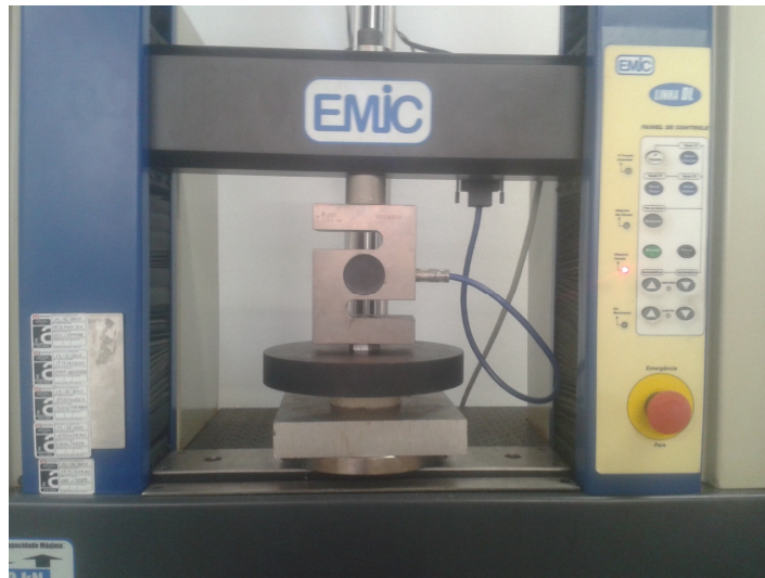
Figura 11. Ensaio mecânico de compressão de amostra de espuma rígida de poliuretano
