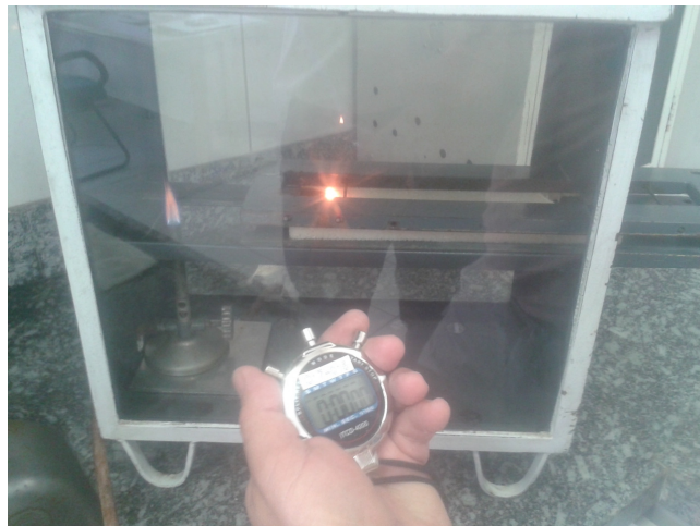
Figura 31. Corpo de prova de espuma de poliuretano durante o ensaio de propagação de chama para materiais aeronáuticos em câmara de inflamabilidade
