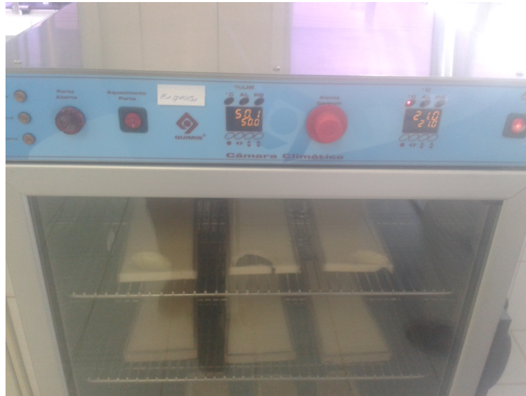
Figura 13. Câmara climática para acondicionamento das amostras antes do ensaio de inflamabilidade
