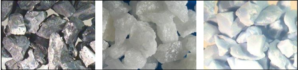
Figura 2.6 - Al 2 O 3 Cinza , Al 2 O 3 Branco e Al 2 O 3 Cerâmico, respectivamente Fonte: Samulewski - 2006
