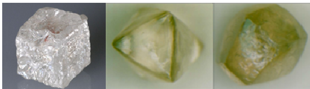
Figura 2.16 - Pedras de diamante - cúbico, octaedro e dodecaedro, respectivamente. Fonte: Procedimentos internos da MAHLE Metal Leve S.A
