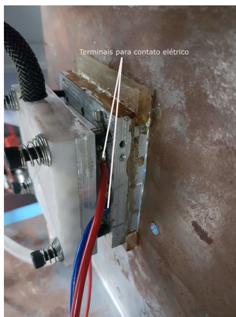
Figura 10 – Plataforma de caracterização - contatos elétricos na mesa de vácuo
