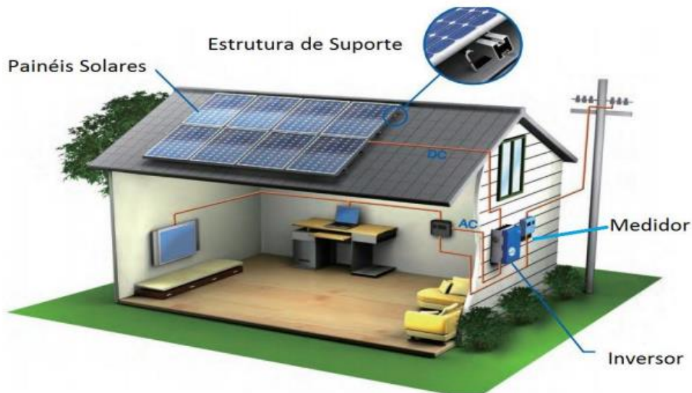
Figura 7: Itens necessários para instalação do sistema “on-grid”.
