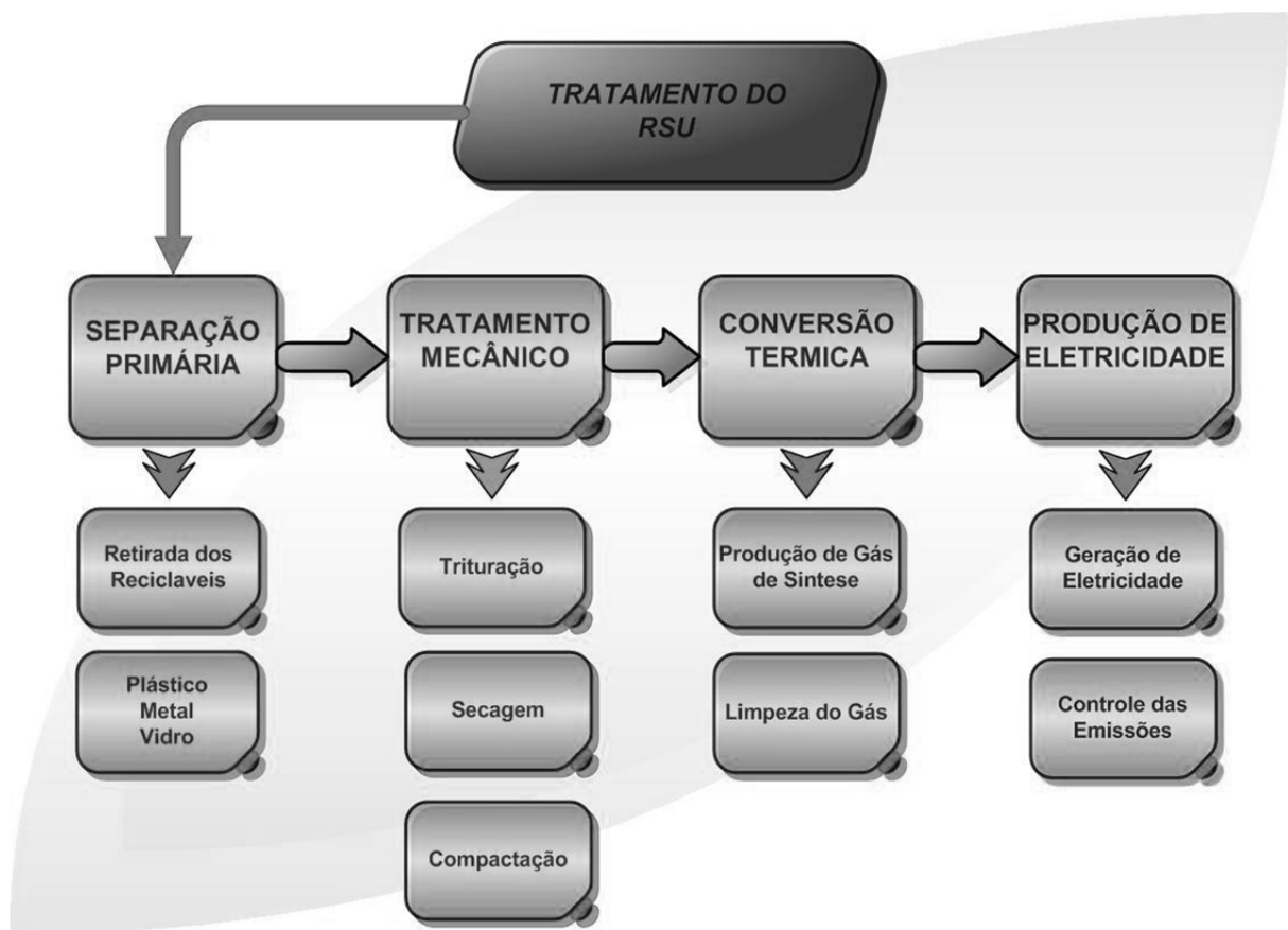
Figura 4.2: Fluxograma para o tratamento do RSU por gaseificação.
