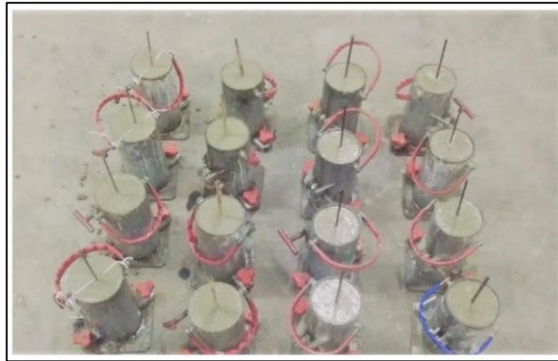
Figura 53 - Preenchimento dos moldes com CAA (grupo 4).
