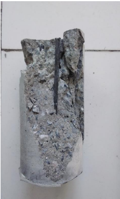
CDPs fraturados correspondentes à configuração G3-BC5:
