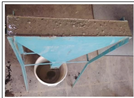
Figura 46 - Método do funil V.
