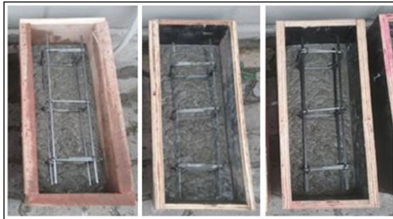
Figura 21 - Preenchimento dos moldes, correspondente a configuração G1-BA, G1-BC1 e G1-BC5, respectivamente.
