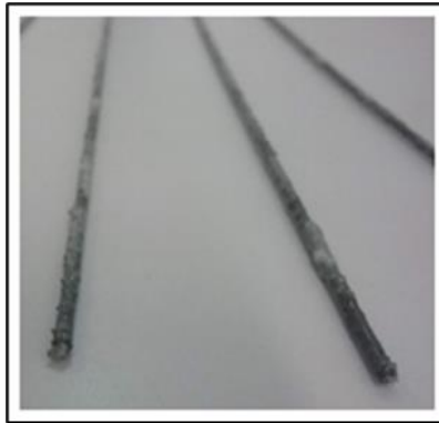
Figura 16 - Barra unitária de PRFC com revestimento de silicato de sódio.
