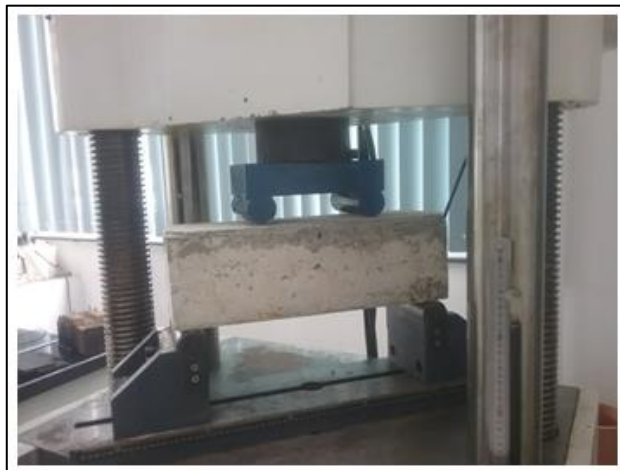
Figura 23 - Ensaio de resistência à tração na flexão em 4 pontos.
