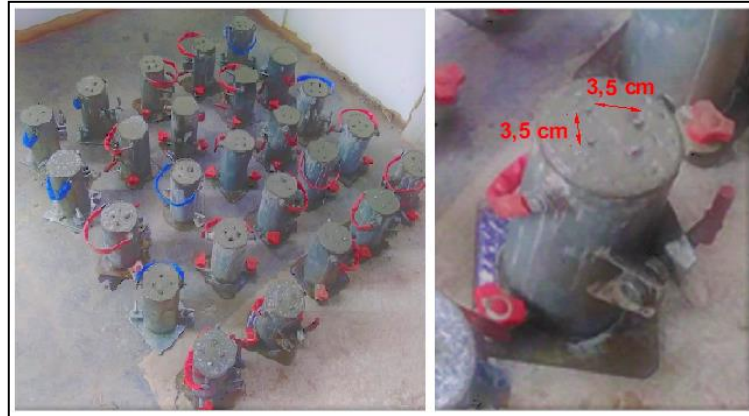
Figura 48 - Preenchimento dos moldes (grupo 3).
