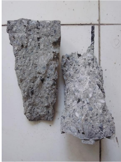
CDPs fraturados correspondentes à configuração G3-BC5-RA:
