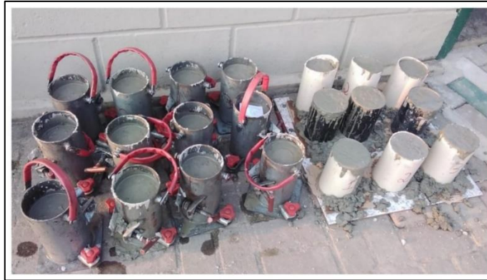
Figura 38 - Preenchimento dos moldes (grupo 2).
