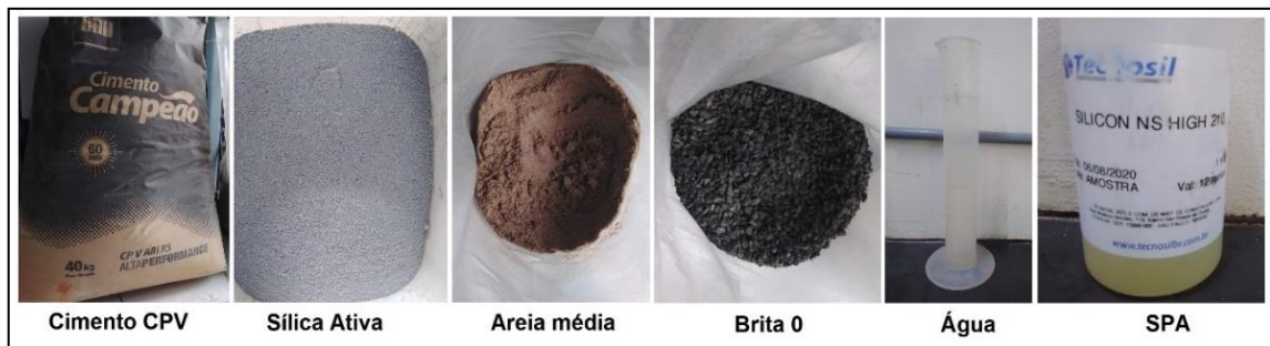
Figura 43 - Materiais Constituintes do CAA.
