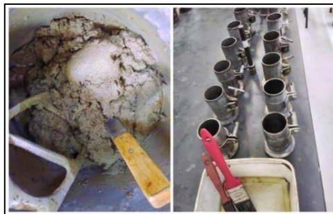
Figura 55 - Preenchimento dos moldes com argamassa (grupo 4).
