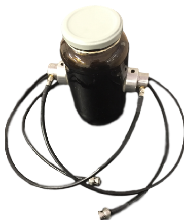
Figura 25 – Cubeta de vidro com os transdutores ultrassônicos.
