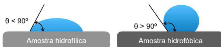
Figura 20. Ilustração representando procedimento de deposição de gota sobre amostras com superfícies hidrofílicas e hidrofóbicas, com destaque para os ângulos de contato.
