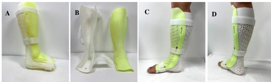
Figura 5. Uso de impressora estereolotográfica para impressão de órtese de tornozelo em ABS, onde (a) é a órtese montada, (b) representa as partes separadas da órtese, (c) e (d) são ângulos lateral e anterior da órtese posicionada sobre um tornozelo humano.
