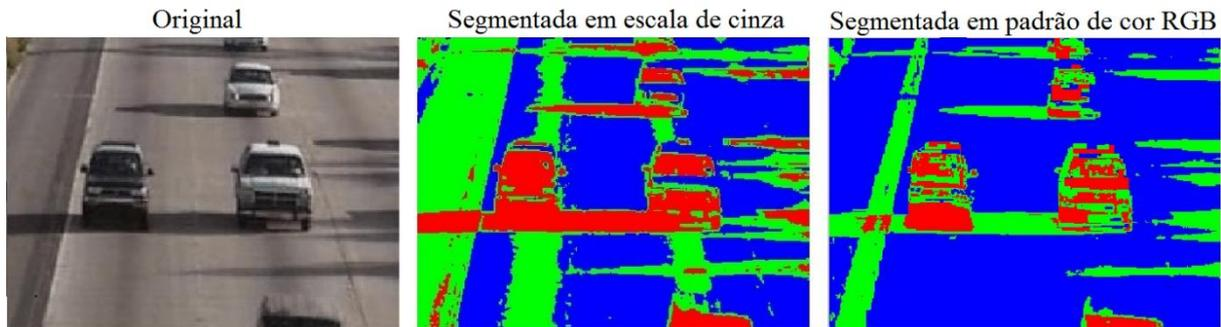
Figura 4.8 - Segmentação através de agrupamentos em escala de cinza e cor.
