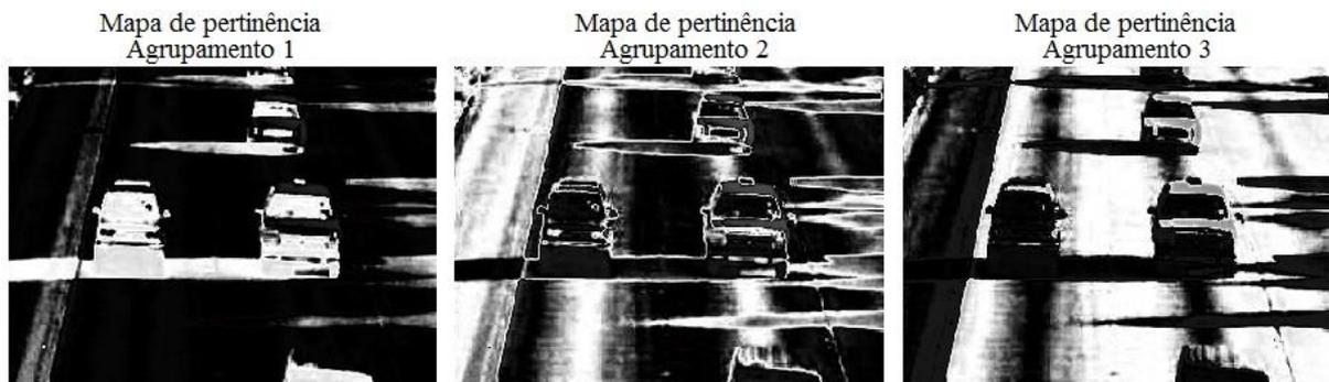
Figura 4.7 - Pixels mapeados conforme a definição inicial de cada agrupamento.
