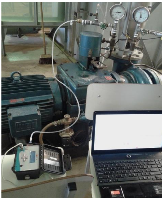
Figura 24 - Manômetro Borden usado para comparação com resultados de pressão obtidos pelo logger de pressão.
