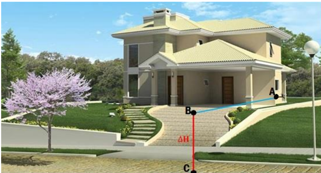
Figura 32 - Desnível do cavalete do ponto de instalação do logger de pressão até o nível da rua.
