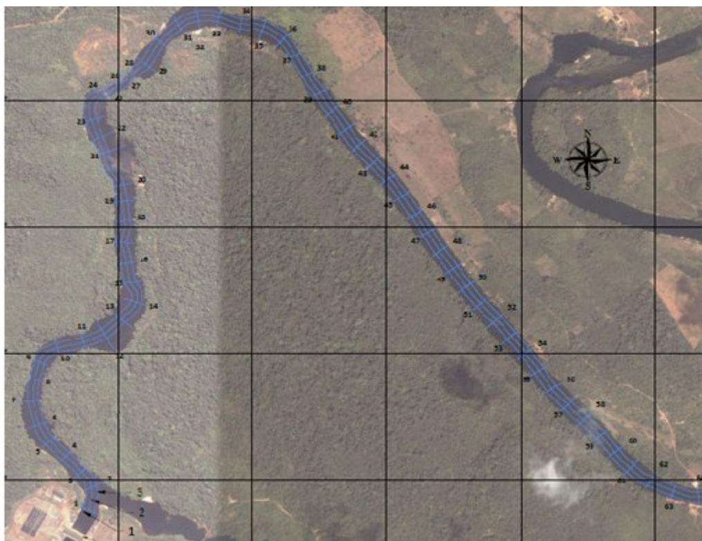
Figura 3.8: Definição de seções para levantamento de perfis do Rio Curuá-Una. (Tiago Filho et al., 2016b)
