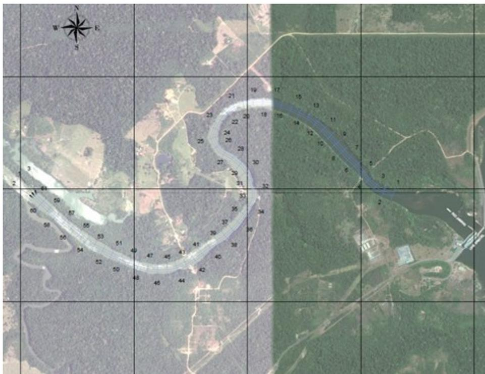
Figura 3.7: Definição de seções para levantamento de perfis do Rio Jamari (Tiago Filho et al., 2016b)
