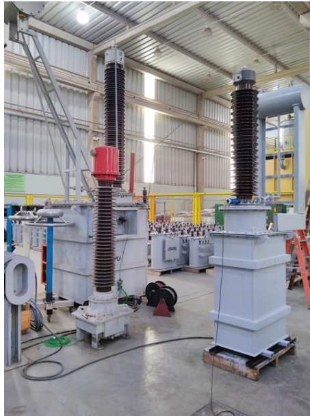
Figura 38 - Foto dos ensaios em laboratório de tensão suportável à frequência industrial, fonte: foto do próprio autor
