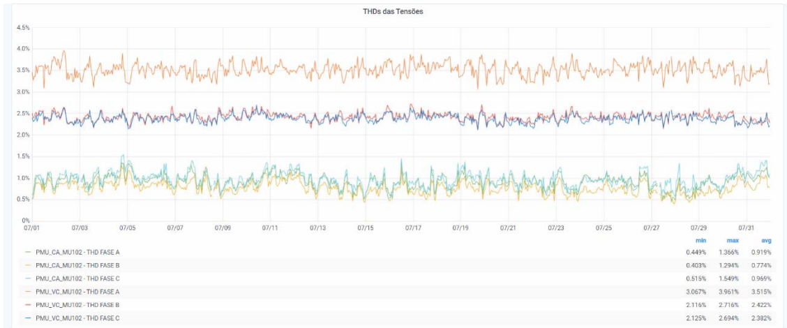
Figura 61 – Valores de THD das tensões trifásicas registradas em 07/2021 - Castanhal e Vila do Conde.
