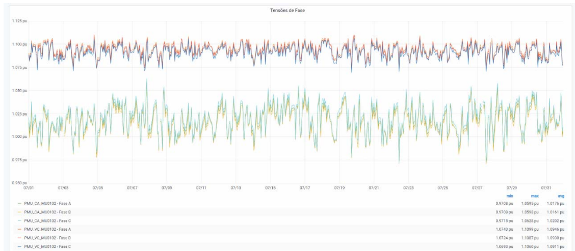
Figura 60 – Valores das tensões trifásicas registradas em 07/2021 - Castanhal e Vila do Conde.
