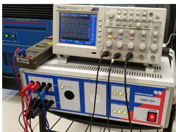
Figura 26 - Validação da caixa amplificadora Omicron CMS156
