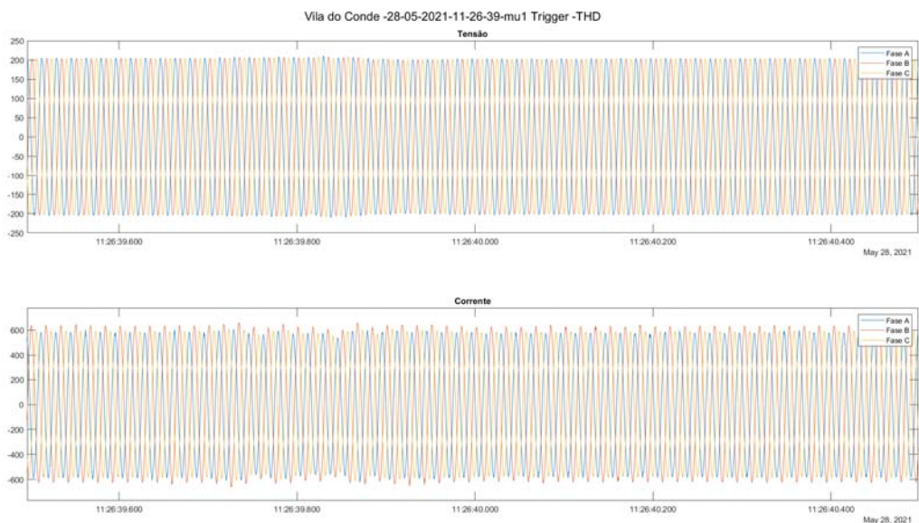
Figura 46 - Oscilografia em Vila do Conde no momento da saída do segundo polo.
