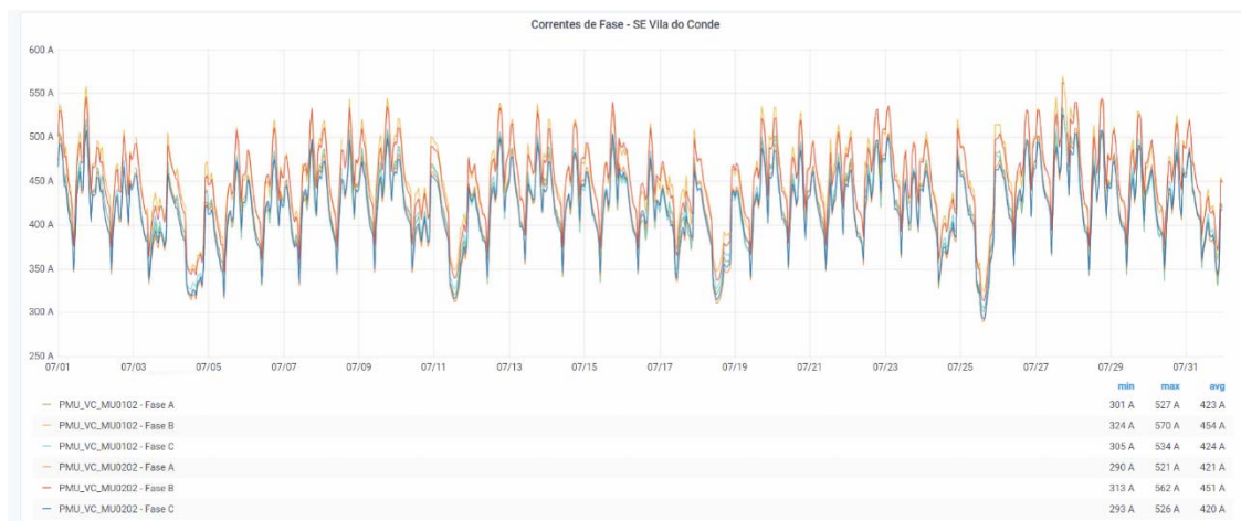
Figura 64 – Valores das correntes trifásicas em 07/2021, na SE Vila do Conde.
