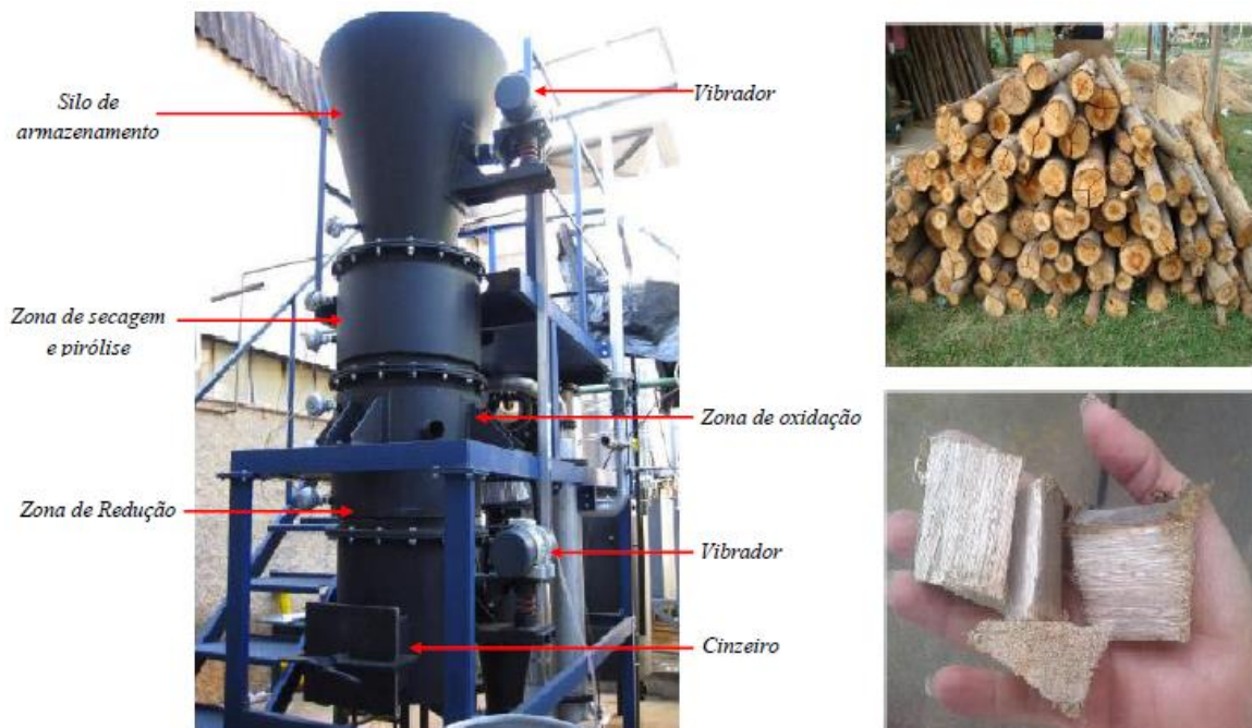
Figura 3.18 Gaseificador de leito fixo tipo co-corrente com duplo estágio de fornecimento ar [22].
