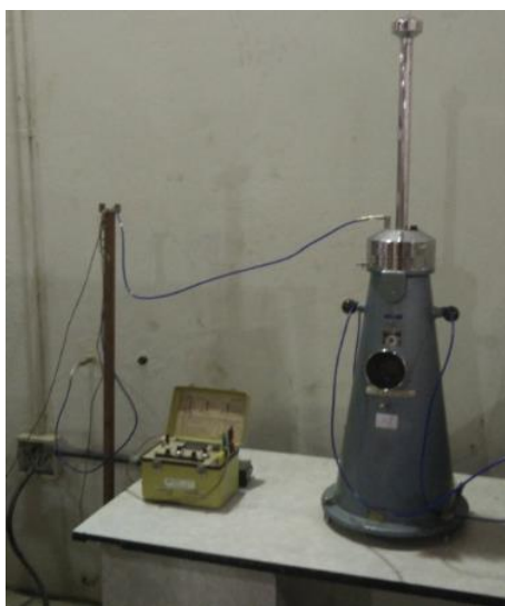
Figura B.5 Ponte extensométrica (à esquerda) e manômetro do tipo Betz (à direita)
