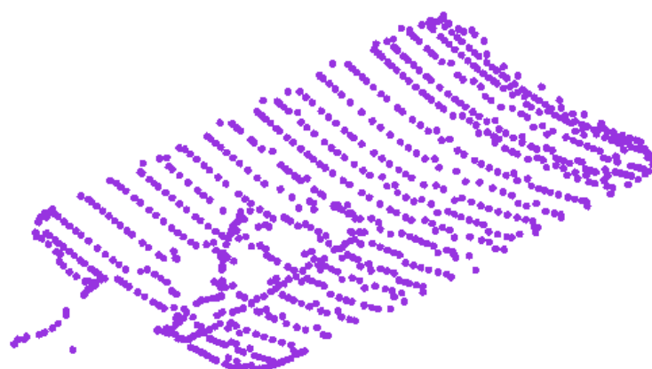
Figura A.4 Nuvem de pontos referente ao lado côncavo (intradorso) de uma da pá do RAM
