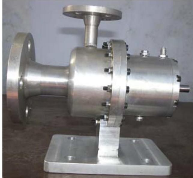
Figura 3.3 Microturbina para ORC. (QIU et al., 2011).
