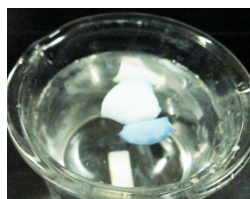
Gambar 4. Uji hidrofobitas tampak aerogel mengapung diatas air
