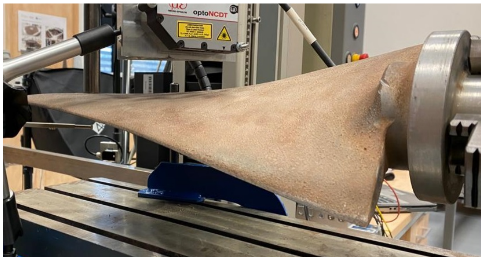
Obrázek 4.8: Experimentálně měřený průhyb hliníkové lopatky.
