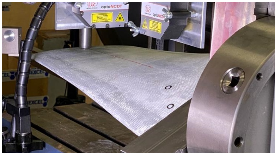
Obrázek 4.16: Experimentálně měřený průhyb sendvičové lopatky.
