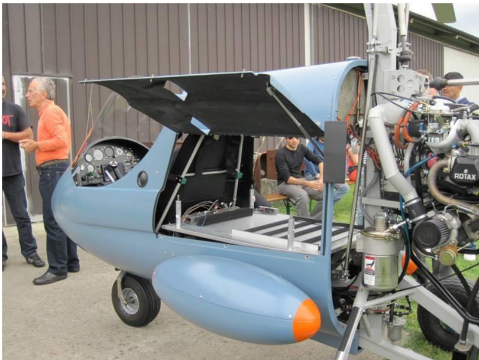
Figura 2 - Particolare della carena del Radgyro con il vano principale per la strumentazione.
