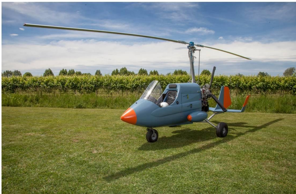
Figura 1 - Il Radgyro, un autogiro dedicato ad acquisizioni airborne multiparametriche.
