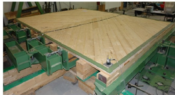
F) Solaio rinforzato mediante doppio tavolato
