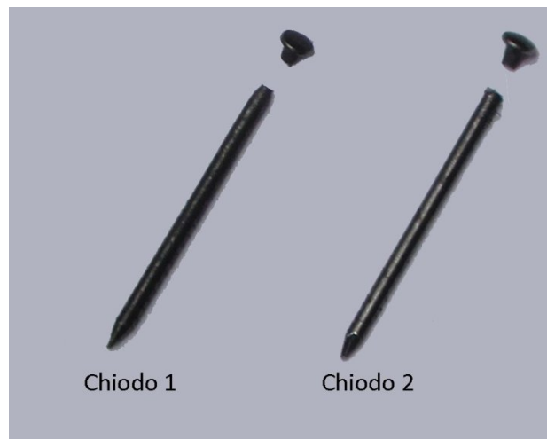
Figura 4.2 – Rottura dei chiodi utilizzati per la determinazione della resistenza.
