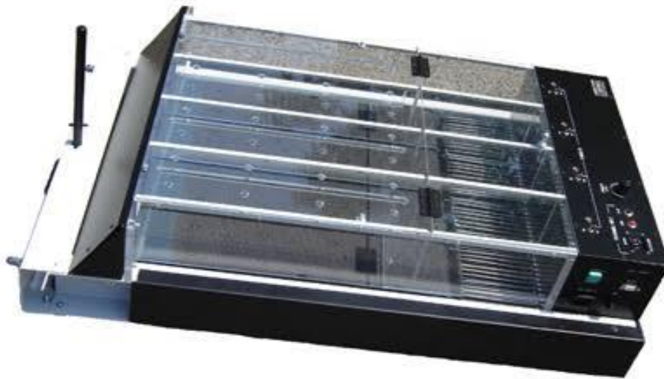
Gambar 2.6 Model Treadmill Tikus dengan 4 jalur. Kelebihan dari penggunaan running treadmill diantaranya, presisi dalam mengatur kecepatan dan durasi, sesuai untuk berbagai jenis intensitas olahraga dan mampu menyebabkan peningkatan kronik akibat latihan, cocok untuk perlakuan pada studi patologi karena kecepatan menentukan kapasitas tikus dan memiliki
