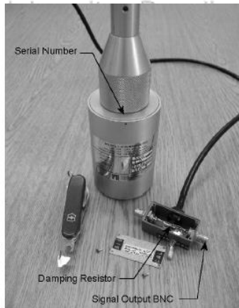
Gambar 2.7 Seismometer 14c dan struktur dari sensor tersebut (Bowden, 2003)
