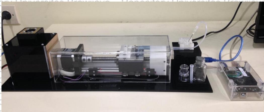
Gambar 5.5. Sistem injeksi cairan *sample* berbasis motor *stepper* dan *syringe pump*.
