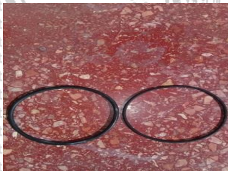
Gambar 4.3 O-Ring seal dengan ketebalan 1.5 mm dan 3 mm
