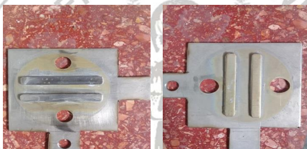
Gambar 4.7 Elektroda bentuk persegi dengan diameter lubang 5, 8, 10, 12 mm
