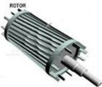
Gambar 2.2 Rotor sangkar pada motor induksi. Sumber : (Sularso & Tahara, 1991)
