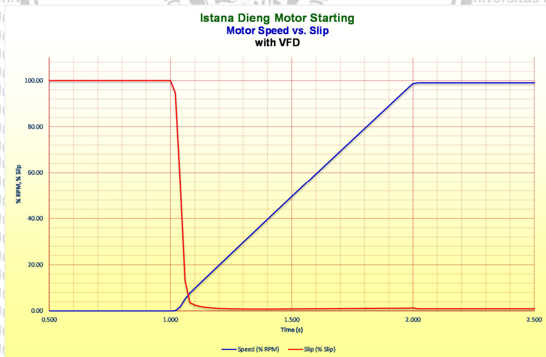
Gambar 5.98 Simulasi motor starting pada salah satu motor pompa pada Rumah Pompa Istana Dieng yang menunjukkan kecepatan motor dan slip motor dengan kondisi menggunakan VFD.
