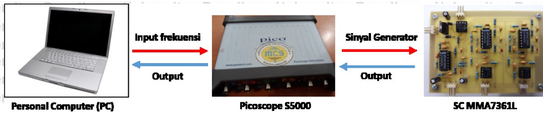
Gambar 5.3 Konfigurasi Pengujian Menggunakan Signal Generator
