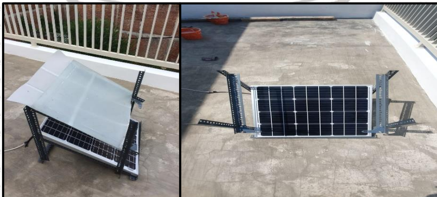
Gambar 5.13. Pengujian dengan Panel Surya yang Tertutup Kertas Kalkir
