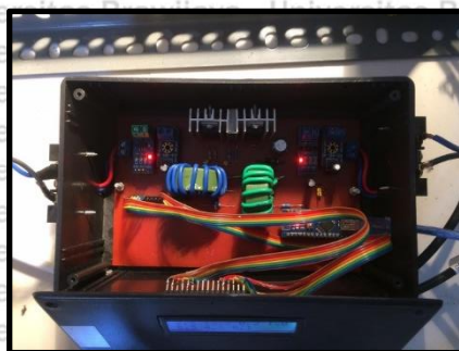
Rangkaian sensor, konverter SEPIC dan Arduino
