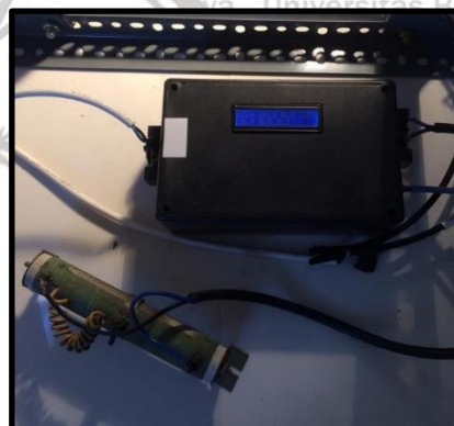
Konverter SEPIC terhubung Resistor
