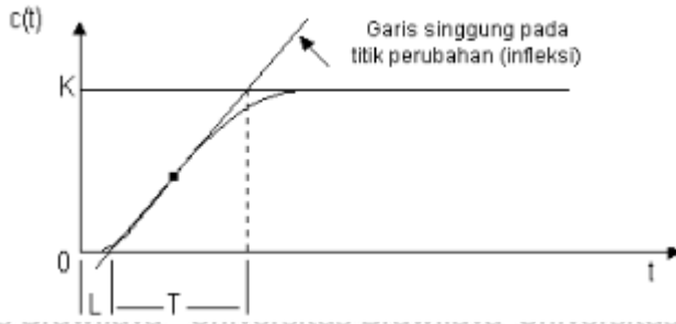
Gambar 2.19. Reaksi Sistem Bekerja Membentuk Kurva S (Sumber: Ogata, 1997)
