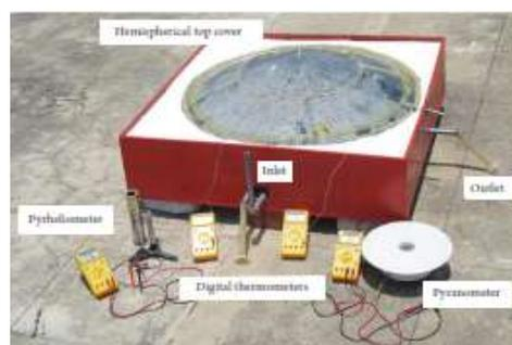
Gambar. 2.10. Solar Still Dengan Penutup Setengah Bola.
