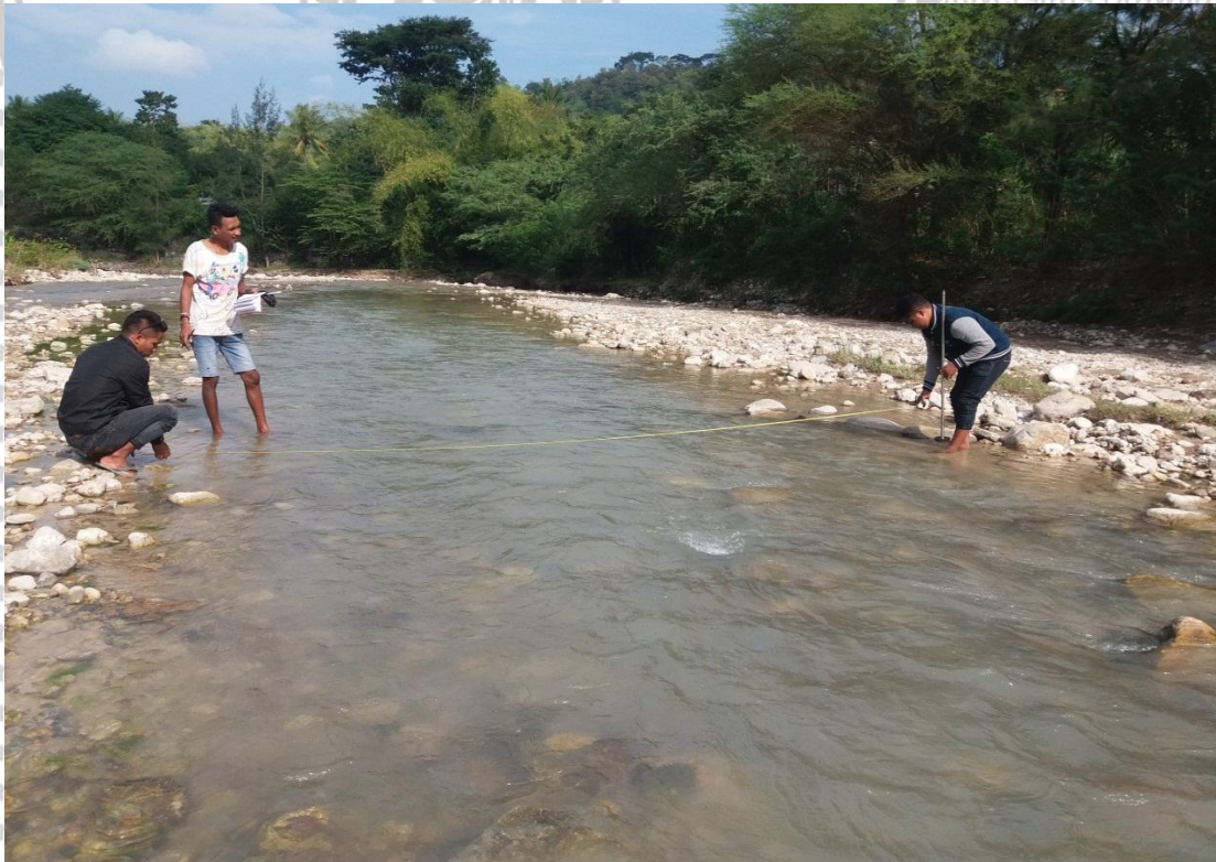
Gambar 1. Pengukuran luas penampang sungai di bagian hulu
