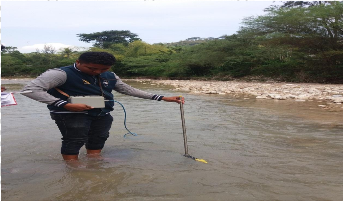
Gambar 3. Pengukuran debit air sungai menggunakan current meter
