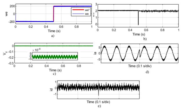
Figure 8. a) Speed, b) electromagnetic torque  $T_{em}$ , c) neutral point voltage  $V_z$ , d)  $i_a$ , e)  $i_d$ .
