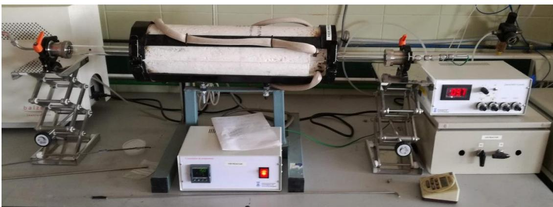
*Ilustración II.1. Horno horizontal utilizado para los tratamientos térmicos.*
