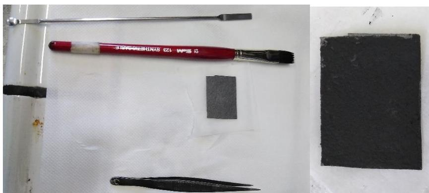
Ilustración II.14. Elementos utilizados para fabricar un electrodo de papel de carbón.
