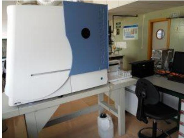
*Ilustración II.8. Equipo de análisis ICP.*
