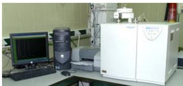
*Ilustración II.7. Equipo de análisis elemental.*
