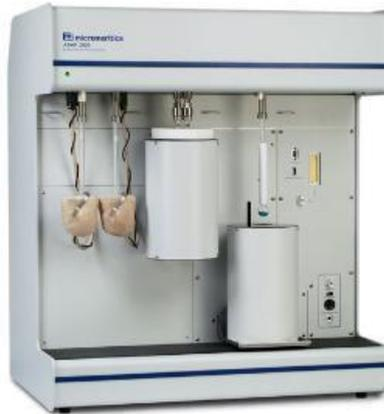
*Ilustración II.11. Equipo de análisis por fisisorción ASAP 2020.*
