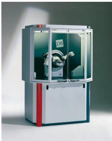
*Ilustración II.3. Equipo de Difracción de rayos X.*
