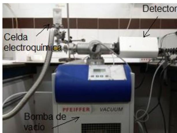
Ilustración II.17. Espectrómetro de masas acoplado a una celda electroquímica de la ULL.
