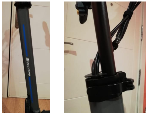
Figura 27 Mástil inferior (izda.). Unión mástil inferior con mástil superior (dcha.)
