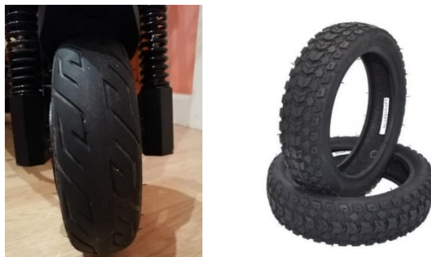
Figura 31 Rueda lisa del patín Smartgyro Speedway (izda.). Rueda todoterreno (dcha.) [23]
