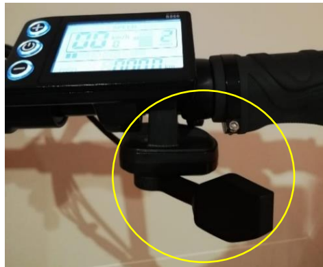
Figura 33 Acelerador marcado con un círculo amarillo (izda.)
