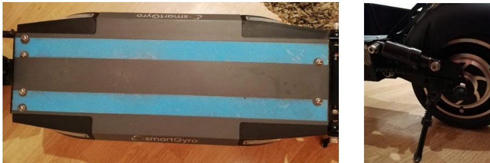
Figura 28 Base del Patín (izda). Pata de cabra (dcha.)
