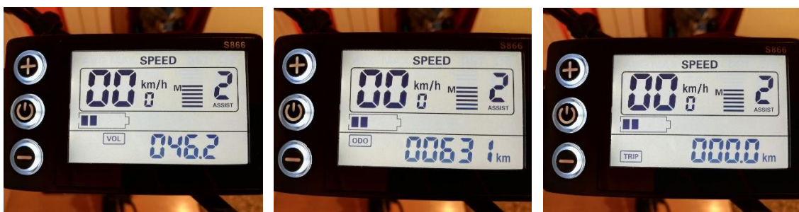
Figura 34 Display marcando la tensión de la batería (dcha.). Display marcando la distancia total (centro).
