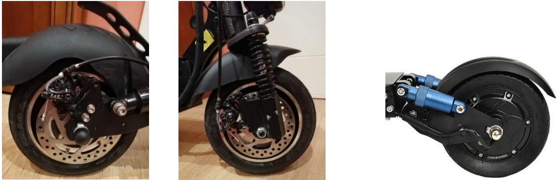
Figura 32 Freno de disco del patín Speedway (izda. y centro) Freno de tambor (dcha.) [24]
