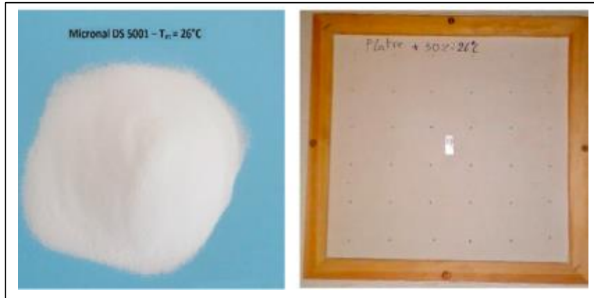
Figura 11. PCM microencapsulado (izquierda) y placa de yeso con PCM microencapsulado (derecha) [3].
