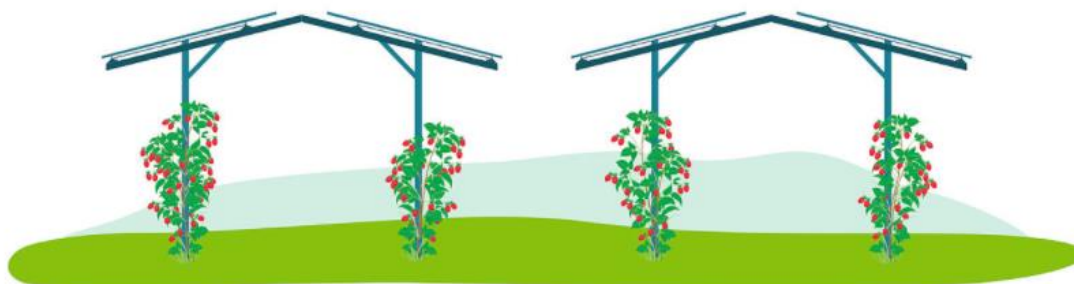
Figura 1. Sistema de montaje fotovoltaico elevado del proyecto agrovoltaico “Fruitvoltaic” de BayWa r.e. [11].
