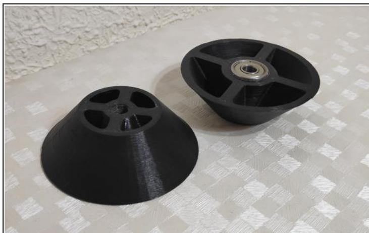
*Ilustración 86 – Piezas cónicas para facilitar el giro de la bobina de filamento*
