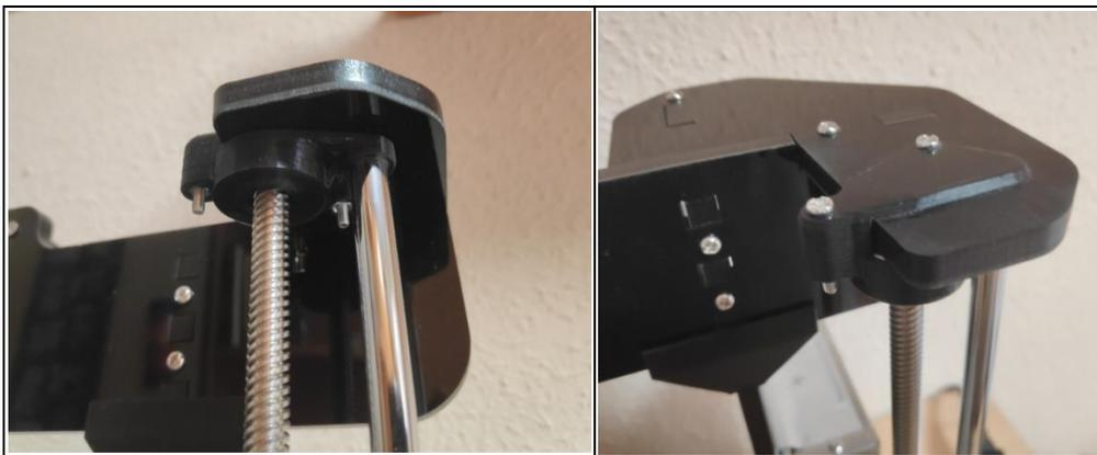
Ilustración 84 – Alojamiento de los rodamientos para mejorar la sujeción de las varillas roscadas del eje Z
