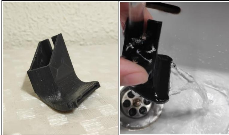
Ilustración 83 – Tobera del ventilador de capa (izquierda) y demostración de su flujo con agua (derecha)
