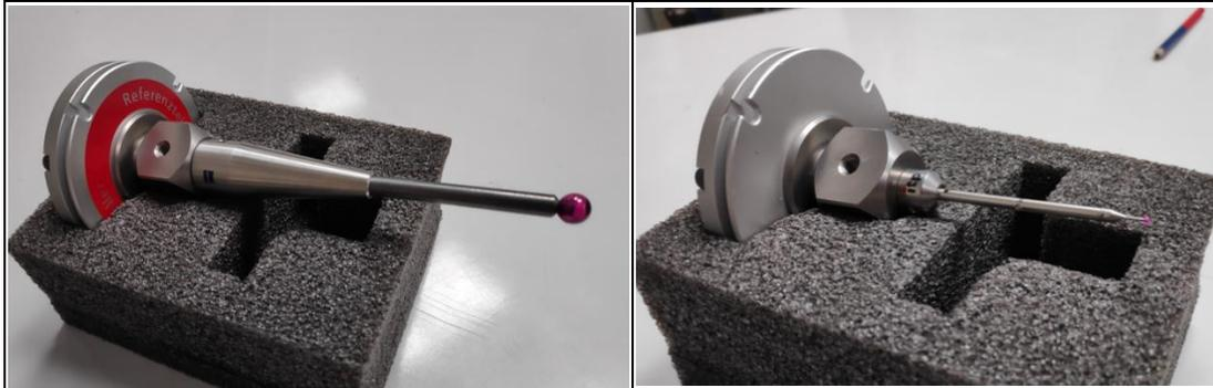
Ilustración 9 – Palpador de calibración (izquierda) y palpador para las mediciones (derecha)
