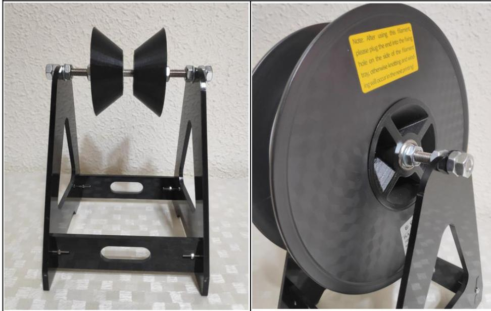
*Ilustración 87 – Funcionamiento de las piezas cónicas en el soporte para el filamento*
