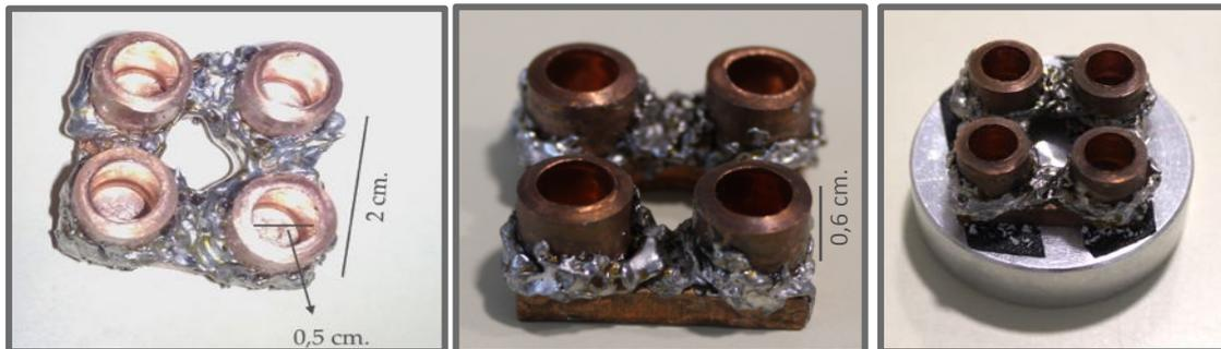
*Fig. 27: Dispositivo de cobre diseñado para la visualización de diferentes muestras de hidroxiapatita bovina con microscopio electrónico de barrido (SEM).*
