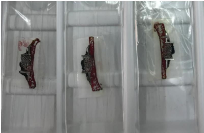
*Fig. 47: Varias muestras tras el corte, pulido, fijación y tinción.*
