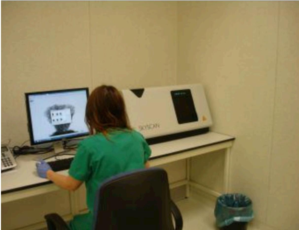
*Fig. 30: Microtomografía computerizada de alta resolución SkyScan 1174 (Bruker; Kontich, Bélgica). Con la colaboración de Vanessa Loredó López y Eva Pascual de la Calle de la Unidad de Imagen Preclínica del Bioterio de la Universidad de Oviedo.*
