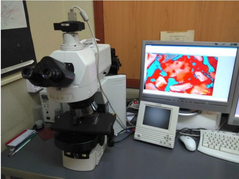
*Fig. 48: Imagen del microscopio óptico (Nikon eclipse 90i, Nikon Instruments Inc, Melville, NY, USA) con la máquina fotográfica acoplada (Nikon digital Sight DS-SMC, Nikon Instruments Inc, Melville, NY, USA) empleado para el estudio de las muestras.*
