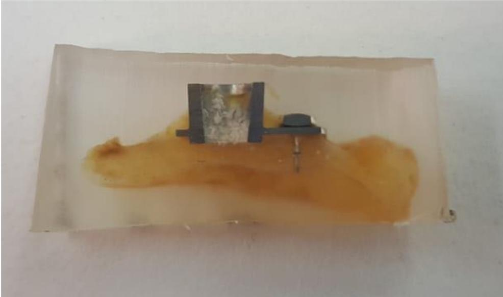
*Fig. 46: Restos del corte de una muestra embebida en metilmetacrilato.*
