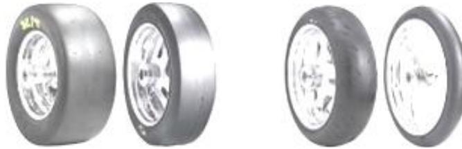
Figura 27. Detalle perfil tipo coche (izda.) y tipo moto (dcha.)
