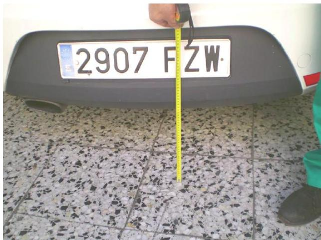
Fotografía 7. Detalle medición altura matrícula
