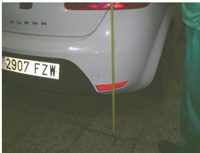
Fotografía 10. Detalle medición altura alumbrado trasero
