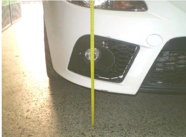
Fotografía 8. Detalle medición altura faros delanteros
