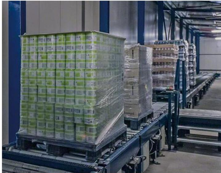
*Ilustración 24. Pistas de rodillos motorizados*
