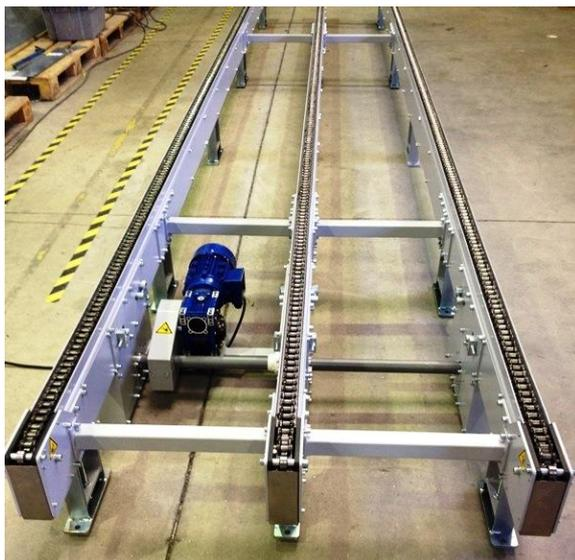
*Ilustración 23. Transporte de cadenas para palés*
