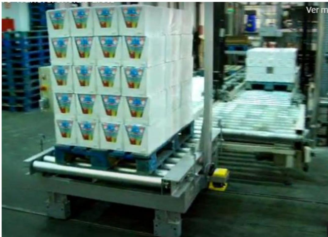
*Ilustración 25. Carro de transferencia*
