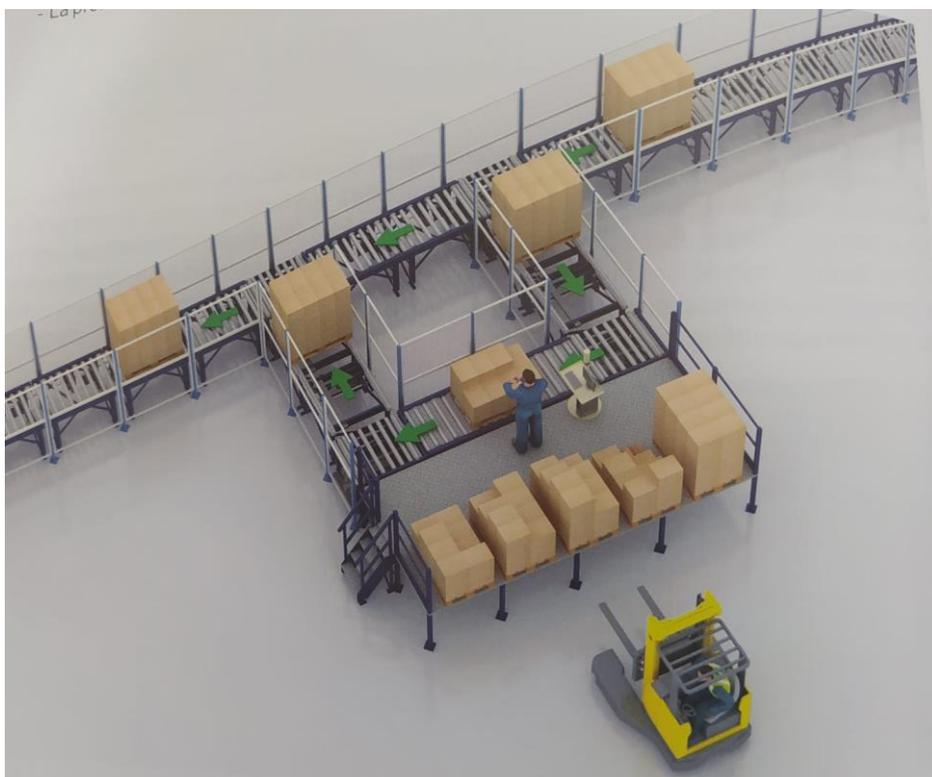
*Ilustración 20. Puesto picking en "U". Fuente: Mecalux*
