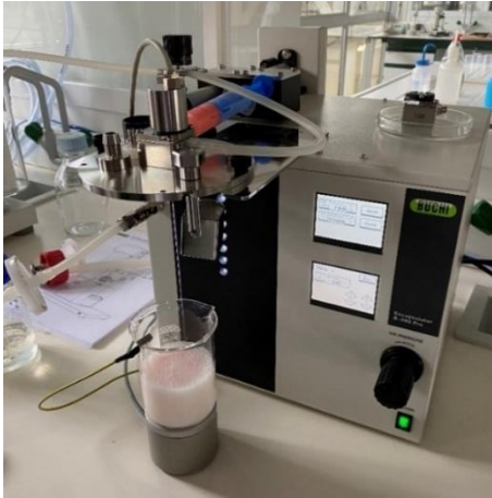
Figura 17: Encapsuladora B-395 pro (BUCHI) en funcionamiento.
