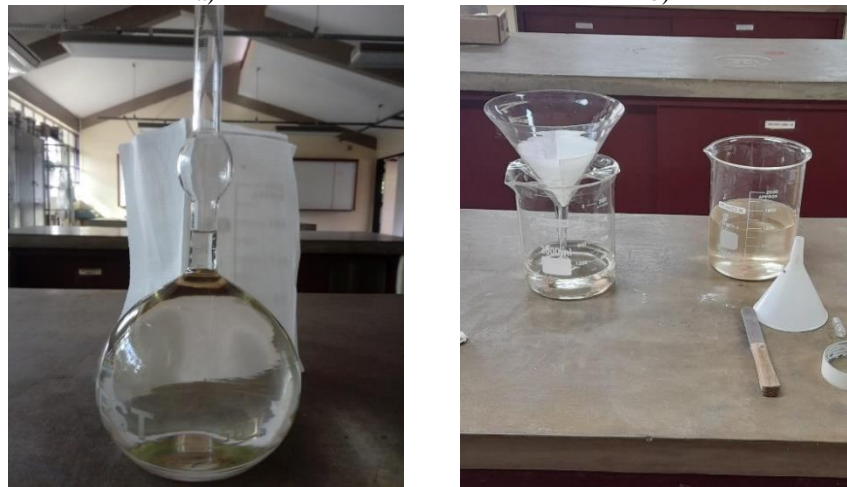
Figura 16 - Massa específica pelo método do frasco de Le Chatelier: a) frasco de Le Chatelier, b) beakers com querosene.
