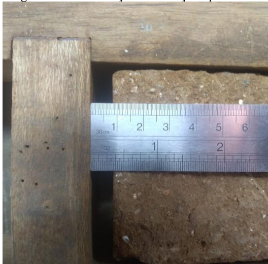
Figura 27 - Verificação da retração após 7 dias.
