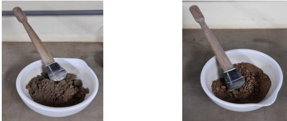
Figura 10 - Desmanche de torrões com almofariz e mão de gral: a) amostra 01, b) amostra 02.
