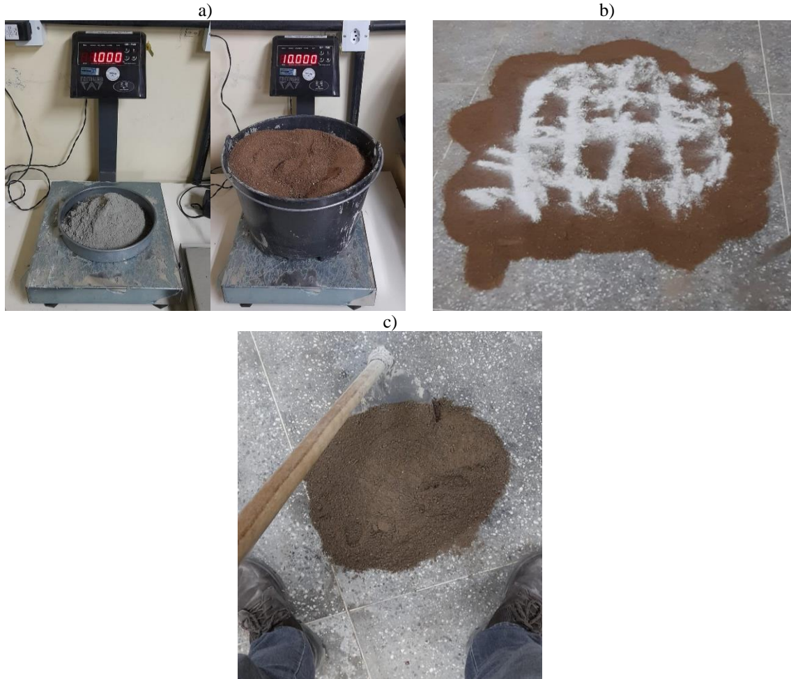
Figura 18 - processo de mistura: a) determinação da massa dos materiais, b) espalhamento, c) mistura homogênea e umectada.
