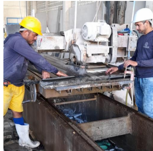
Figura 8 - Processo de geração do resíduo. a) armazenamento das rochas, b) processo de corte, c) processo de acabamento, d) calha para escoamento da água com resíduo, e) tanques de decantação.
