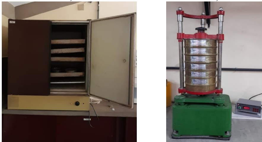
Figura 15 - Itens utilizado para ensaio de peneiramento: a) estufa, b) conjunto de peneiras no peneirador mecânico.
