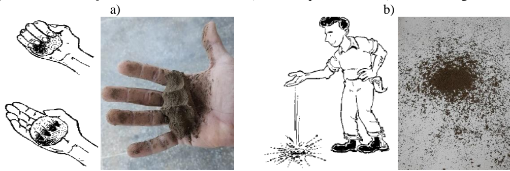
Figura 19 – Verificação da umidade da mistura: a) material pressionado, b) amostra atingindo o chão.
