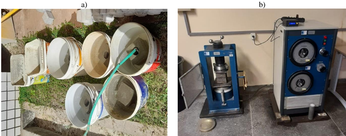
Figura 25 - Etapas do ensaio de compressão: a) corpos submersos em água, b) prensa hidráulica.
