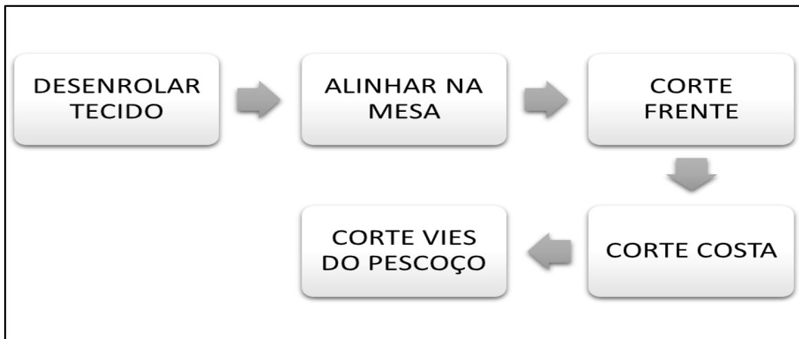
FIGURA 2: Esquema de corte da bata cirúrgica
