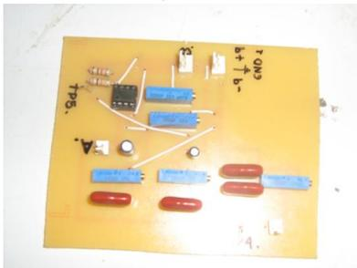
**Figura 3. Tarjeta 2. Filtro notch y filtro paso bajo**
