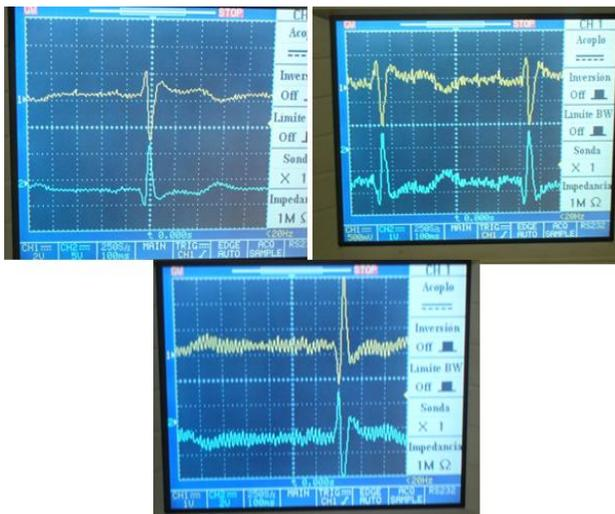
**Figura. 19** Punto de prueba TP6 derivación 1 (RA-LA) TP6-azul, TP4- amarillo, TP6 derivación 2 (RA-LL), TP6-azul tp4- amarillo. TP6 derivación 3 (LA-LL), TP6-azul TP4- amarillo
