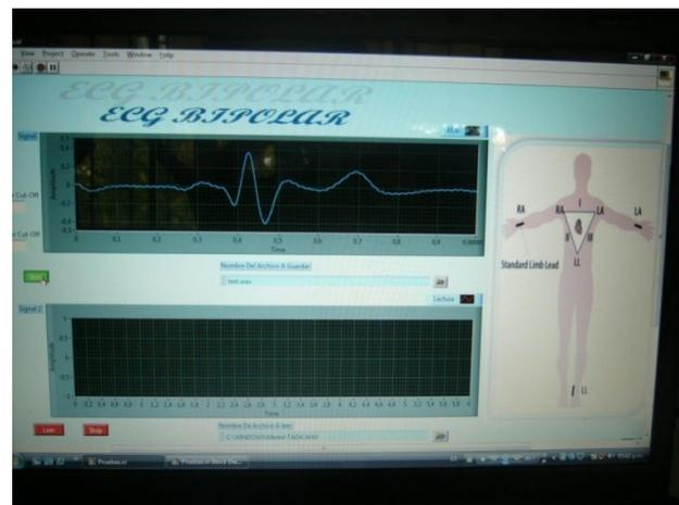
**Figura 23.** Panel frontal ECG en Labview
