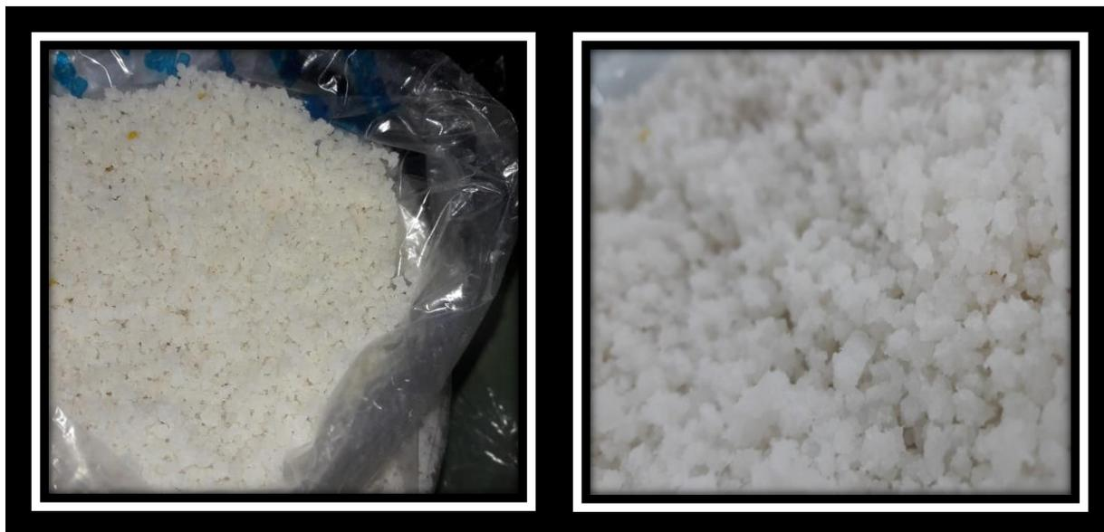
*Figura 5.* Plástico triturado lavado y limpio.
