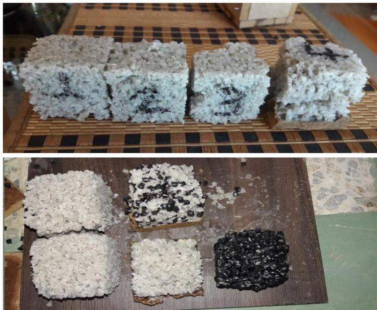
*Figura 12.* Bloques de plástico reciclado de densidad alta y baja
