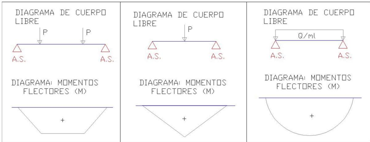
Figura 22: Tipos de diagramas de Momentos Flexionantes - parte 1
